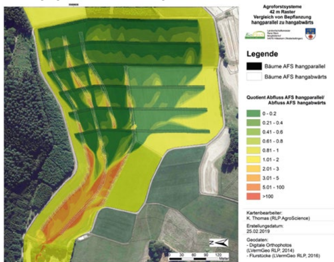
Abb. 1: Vergleich der Abflussrate zwischen hangparallel und hangabwärts gepflanzten Agrarholzstreifen.
